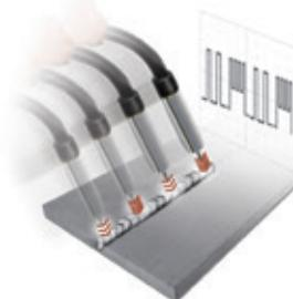
Consente di ottenere una migliore lavorazione degli spessori sottili e una particolare estetica del cordone di saldatura.
